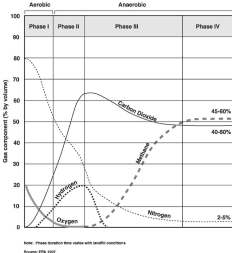
**FIGURE 2: PRODUCTION PHASES OF TYPICAL LANDFILL GAS**
